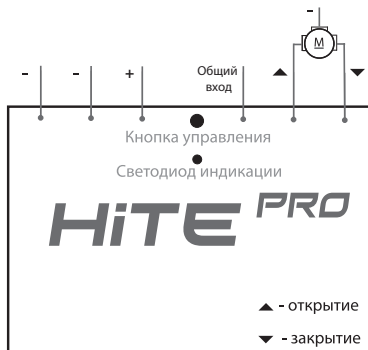
Схема подключения Relay-Drive/12V с выходом «сухой контакт»
